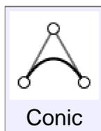
Dessiner une courbe conique (soit une parabole, une hyperbole ou un segment d'ellipse) à partir d'un bâti de 3 points, ou par un point et un coefficient Rho.
