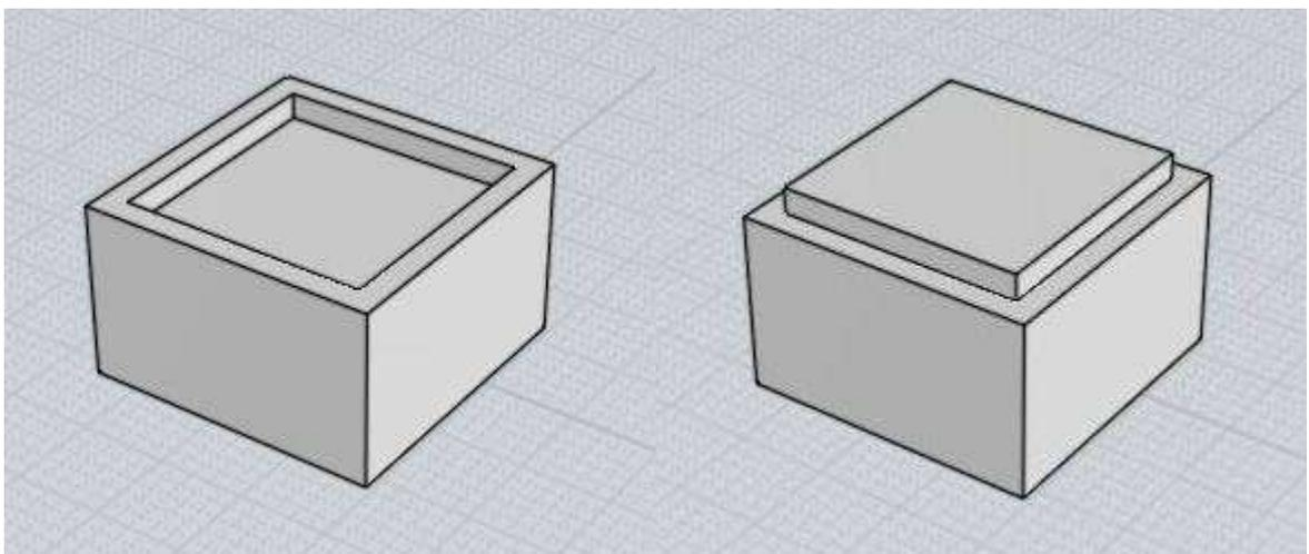
Lorsque la direction est réglée sur "l'extérieur" une case à cocher supplémentaire apparaît "Développer" qui peut être configurée pour faire croître le contour du panneau en taille plutôt que de le diminuer. Cela fait une sorte d'effet de chapeau:
