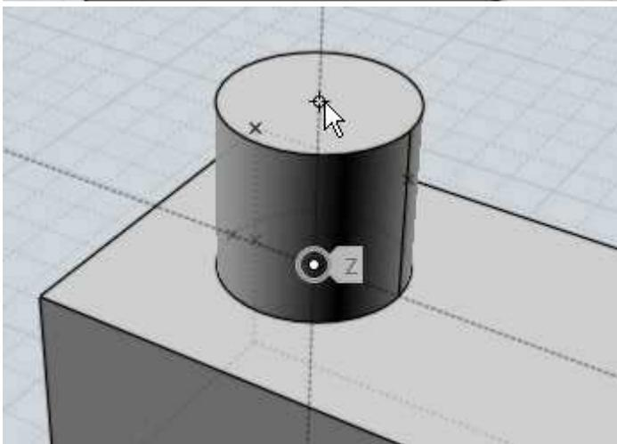
**"Rotation Ligne d'Aide"** vous permet de pivoter une Ligne de Construction tournant autour de sa base avec un angle donné.
