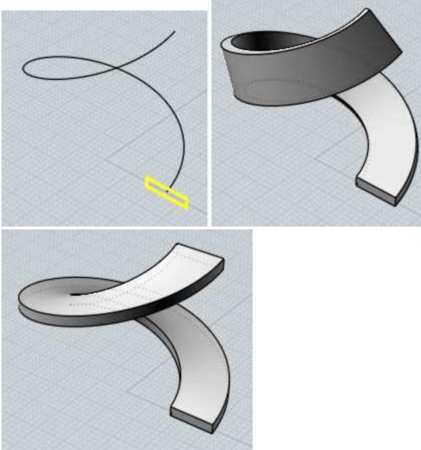
L'option **"Rail de Mesure"** vous permet de choisir une courbe de rail additionnel, lequel pourra déformer le tubage.
