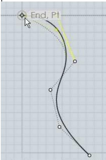
Ce résultat donnera 2 points alignés horizontalement et maintenant la courbe pourra être symétrisée sans former de pli:
