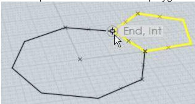
Le second point d'axe est pointé sur le même côté du polygone:
