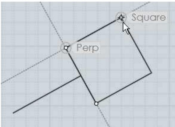
Les Lignes de Construction peuvent être utilisées de cette manière à la façon d'un échafaudage de trames temporaires adaptées à l'orientation et la taille des objets existants.
