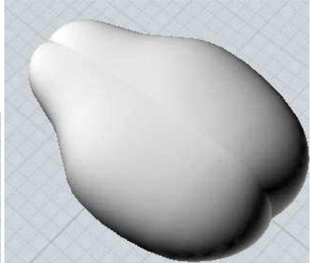
La raison de cette pliure est que les différentes formes de rails causent quelques distorsions de la forme du profil comme s'il avait glissé le long de ceux-ci avec une légère différence de distance.
