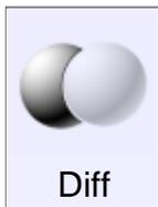
Coupe un objet par la soustraction volumique d'un autre.
