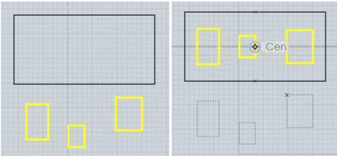
Un autre usage de la commande "Aligne" est d'ajuster les 2 points de contrôles de la fin d'une courbe pour les aligner exactement à l'horizontale ou la verticale l'un de l'autre.
