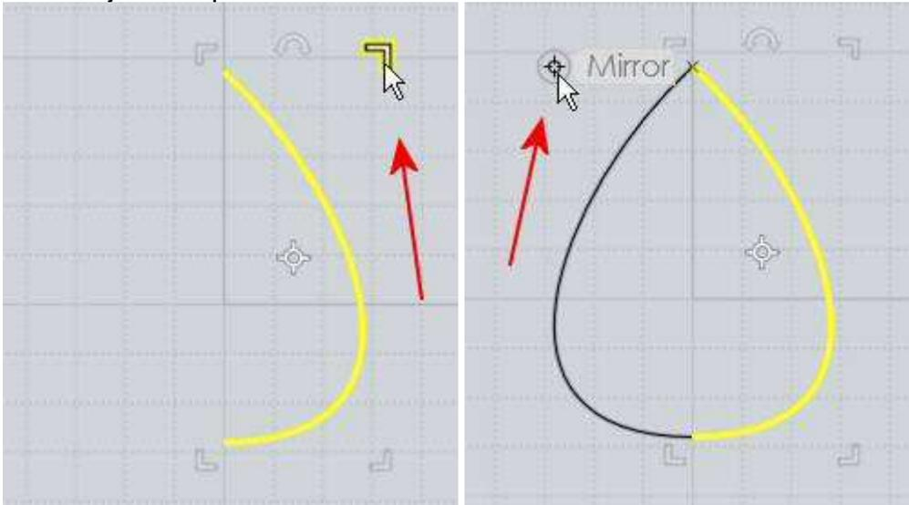
Ainsi, si vous faite une mise à l'échelle du centre, il y a des points de "Snap" au miroir des 3 autres coins pour permettre une exacte "mise en place" de type Flip ou miroir.
