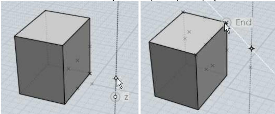
Ici un exemple de projection servant à placer le point sommital d'un cylindre à une égale hauteur d'un objet boîte existant.
