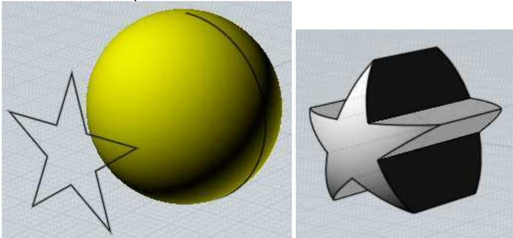
L'intersection booléenne peut aussi être très utile pour créer rapidement un modèle massif 3D étant la combinaison de 2 profils 2D placés à 90°.
