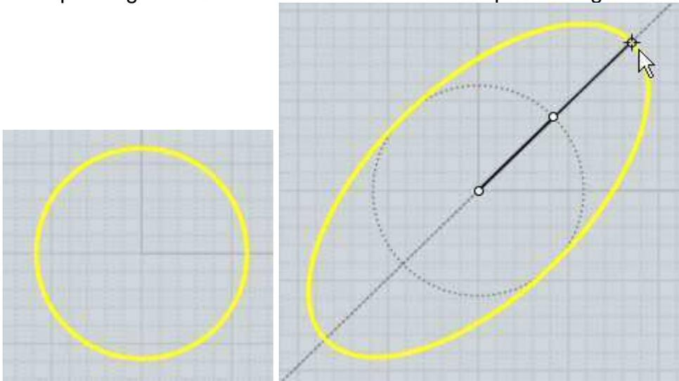
Taille 1D peut aussi être utilisée pour allonger ou rétrécir un objet à une nouvelle taille tout en gardant ses formes inchangées sur X et Y.
