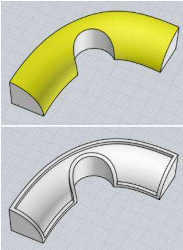
La distance d'épaisseur définit la taille de la bordure de la façon dont la mesure se rétrécit dans le panneau de la frontière, et aussi dans quelle mesure il la dépasse. La hauteur de protrusion peut être réglée séparément si vous le souhaitez, par l'utilisation de l'option "séparée". Vous pouvez définir l'épaisseur soit en tapant une valeur ou en cliquant 2 points à l'intérieur d'une fenêtre qui donnera comme épaisseur la distance entre ces 2 points.
