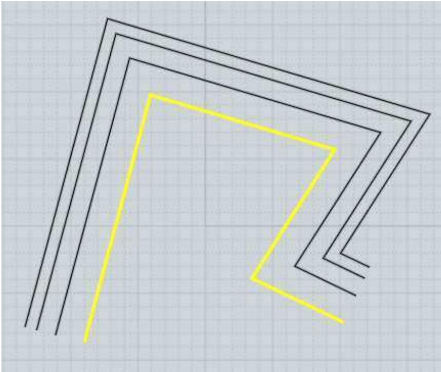
"Offset" tend à être utilisé le plus souvent avec des courbes, et la commande "Coque" le plus souvent utilisée avec des solides ou des surfaces.
