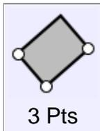
Dessine une surface rectangulaire par 3 points: 2 pour un côté et le 3ème pour la largeur, similaire à Rectangle 3 Pts.
