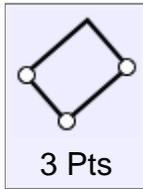
Dessine une boîte solide, commençant par une base rectangulaire par 3 points, 2 pour un côté, et un 3ème pour la largeur, suivi d'une extrusion.
