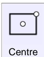
Dessine une boîte solide, commençant par une base rectangulaire par un centre et un coin, suivit d'une extrusion.
