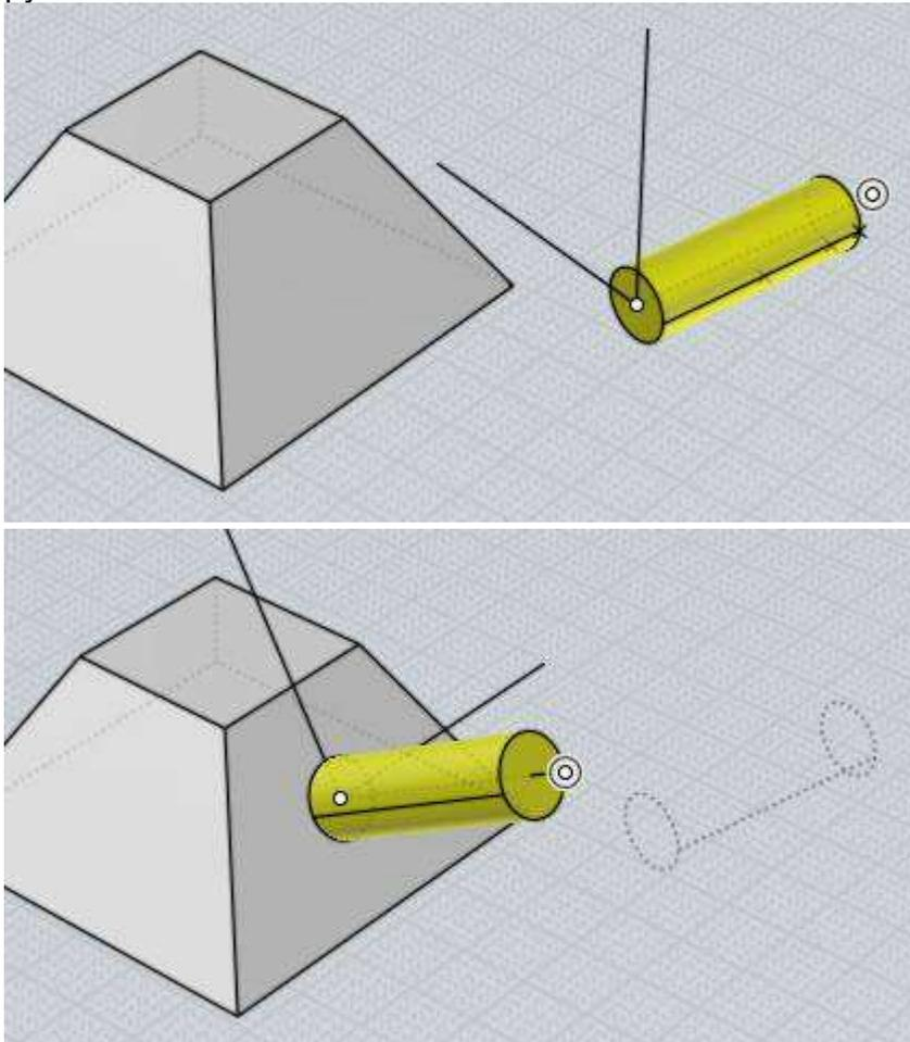
Pour utiliser Oriente vous cherchez une orientation de base, et ensuite une orientation de la cible, et les objets sélectionnés seront cartographiés à partir de la base de la cible.
