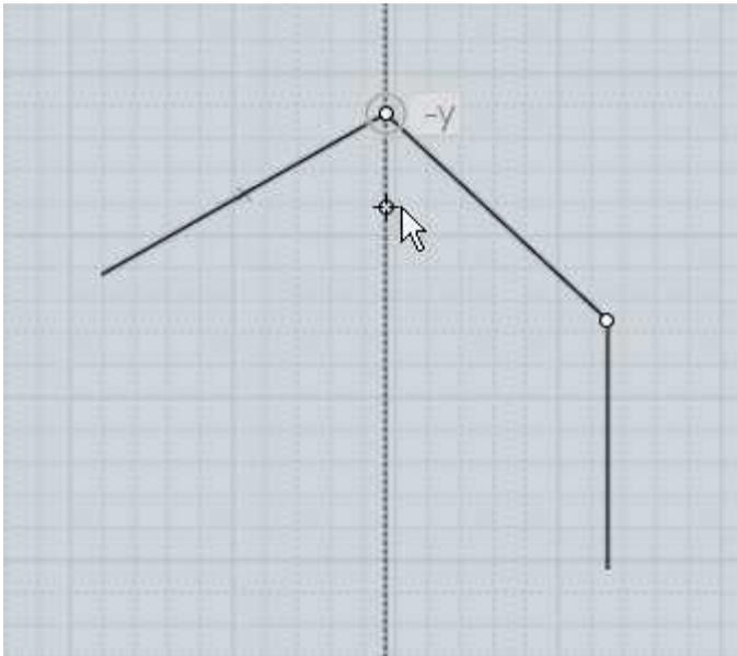
Maintenant que la Ligne de Construction est dessinée depuis ce point, vous pouvez trouver un point d'intersection entre la ligne horizontale et la Ligne de Construction verticale.
