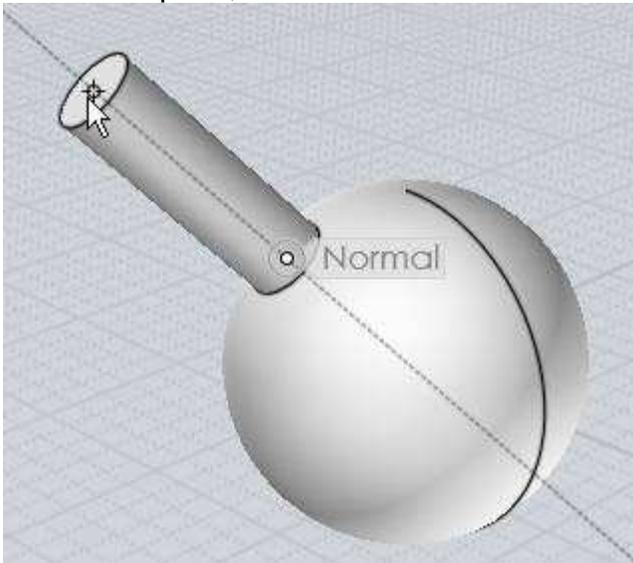
Pour éviter une rupture, il y aura seulement une droite ligne de capture à la fois à la normale à la surface.
