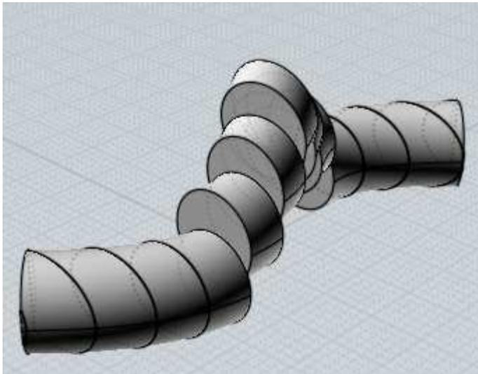
Il est aussi possible de faire une différence d'un solide par une surface ouverte non solide.
