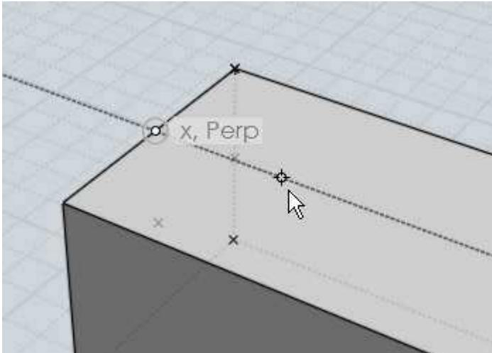
Maintenant il y a les points d'accrocher valides avec le même espacement que sur le bord pour dessiner un cylindre exactement positionné:
