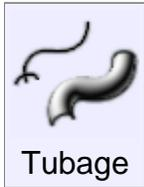
Crée un solide ou une surface passant par les profilés des sections de coupe, guidé par une ou deux courbes de chemin : le "Rail".
