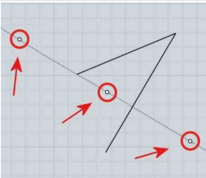
Cela fait qu'il est possible de trouver le milieu entre 2 points quelconques en traçant une Ligne de Construction entre ces 2 points.
