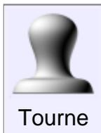
Crée un solide ou une surface en traçant un contour pivotant autour d'un axe.
