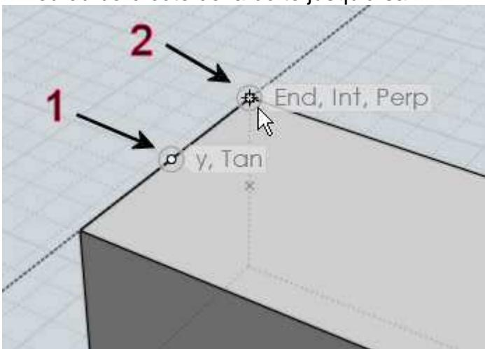
Puis la Ligne de Construction est réorientée perpendiculairement au côté, vers l'intérieur du dessus du sommet de la boîte:
