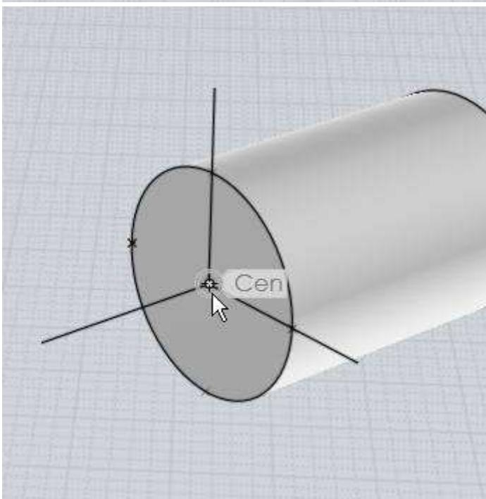
En plus de la surface des normales, le sélecteur peut également s'aligner sur le plan d'un cercle ou un rectangle courbe quand il est calé à leurs points de centre, ou à la tangente d'une courbe quand il est calé jusqu'à un point sur une courbe.
