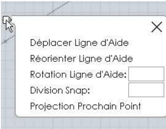
**"Déplacer Ligne d'Aide"** vous permet de pointer un autre point pour y déplacer la ligne, basiquement il suffit de bouger la Ligne de Construction à sa nouvelle position.
